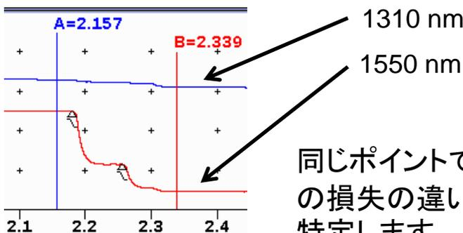
同じポイントでの1310 nmと1550 nmの損失の違いから、曲げ損失箇所を特定します。
