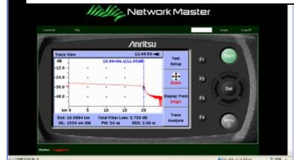
Wi-Fi, Ethernet機能では、ファイルの共有に加えてリモートGUI機能を使うことができます。
