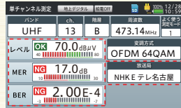
受信レベル、MER、放送局名をひと目で確認できる測定画面
