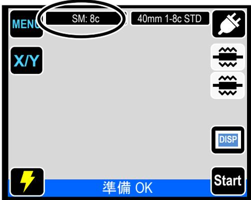
1: 「SM:8c」条件が選択されています。始めに接続条件選択画面に移動します。この例では「NZDS」カテゴリを選択します。
