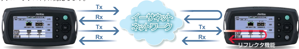
ループバックまたはリフレクタ機能を使ったシングルエンド試験 2ポート同時試験で多ポート試験を効率化
