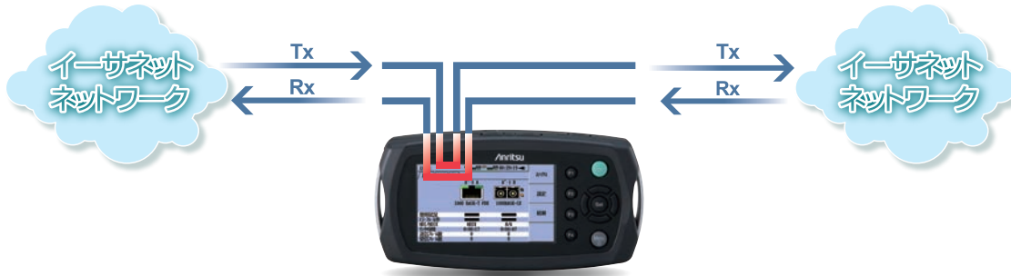
ネットワークの間に入れてパススルーモニタリング 2ポートのTx、Rxを使用
