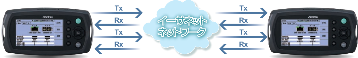
エンドツーエンド試験で双方向のパフォーマンスを個別、または同時に試験 2ポート同時試験で多ポート試験を効率化
