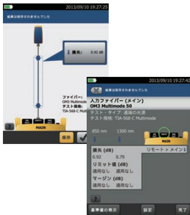
単芯の光ファイバーの損失を 2 波長同時に測定
