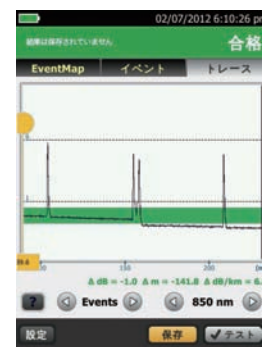
中央にあるピークは2つの イベントで構成されている 事が瞬時に分かりました。
