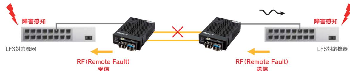
※DN6820EはLPT(Link Pass Through)機能を実装していませんが、DN6820Eが接続される端末機器側のLFS(Link Fault Signaling)機能を使うことによって、LPT機能と同様の効果が得られます。
