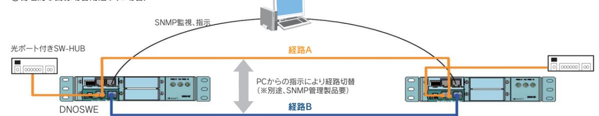
本製品をSNMP監視ユニット(9830含む)を組み合わせたラックに搭載することで、遠隔からの経路切替が可能です。経路切替方法は、TelnetによるCLI入力・WebブラウザもしくはSNMP Managerから制御となります。
