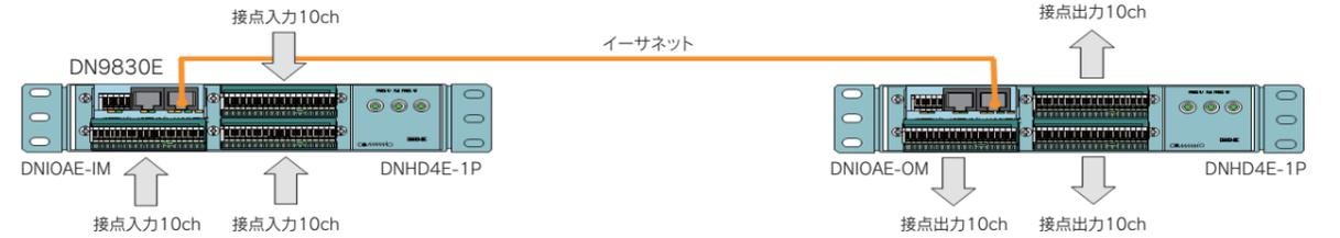
本製品をDNHD4E(ラックオプション)に搭載し、DNOAE-IM(入力)/OM(出力)と組み合わせることで、30ch分までの接点伝送が可能です。小規模な接点伝送システムに適しており、必要接点数に応じて、10ch単位で10~30chまで構成を組むことができます。また、上記構成のような接点⇄イーサ⇄接点だけではなく、PCからSNMP(MIB)、CLI、Webブラウザ経由で接点出力の制御や接点状態の監視もできます。In/Out4ch時にはDNOAE-Aと直接接続する構成でも使用できます。※詳細構成については、お近くの営業窓口までご相談ください。
